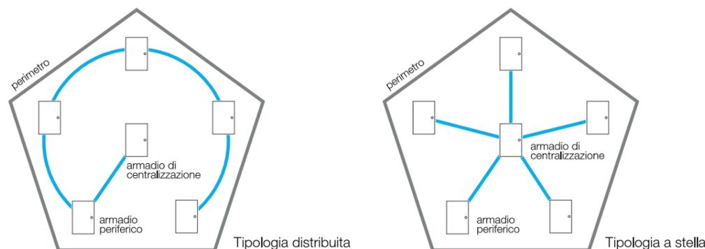
Nella topologia a stella si creano invece più linee di comunicazione di tipo bus che escono dall'armadio di centralizzazione e si diramano verso i vari armadi periferici. In questo caso i DN HT REPEATER utilizzati per realizzare ciascuna derivazione del bus si trovano tutti all'interno dell'armadio di centralizzazione. Su ogni ramo del bus si possono connettere massimo 16 schede di elaborazione, inoltre ogni ramo può coprire una distanza massima di 1,5 km.
