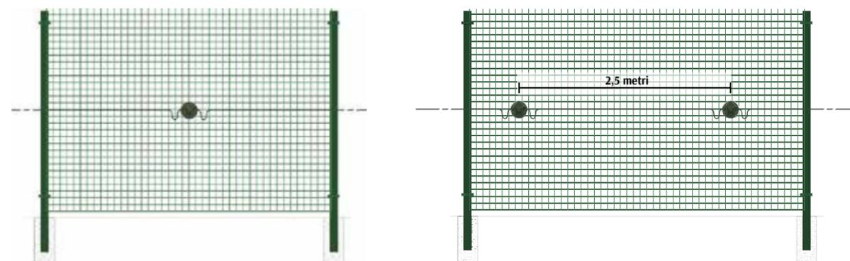
Esempio d'installazione del sensore su recinzione con distanza tra i pali di 2, 2,5 o 3 metri.
