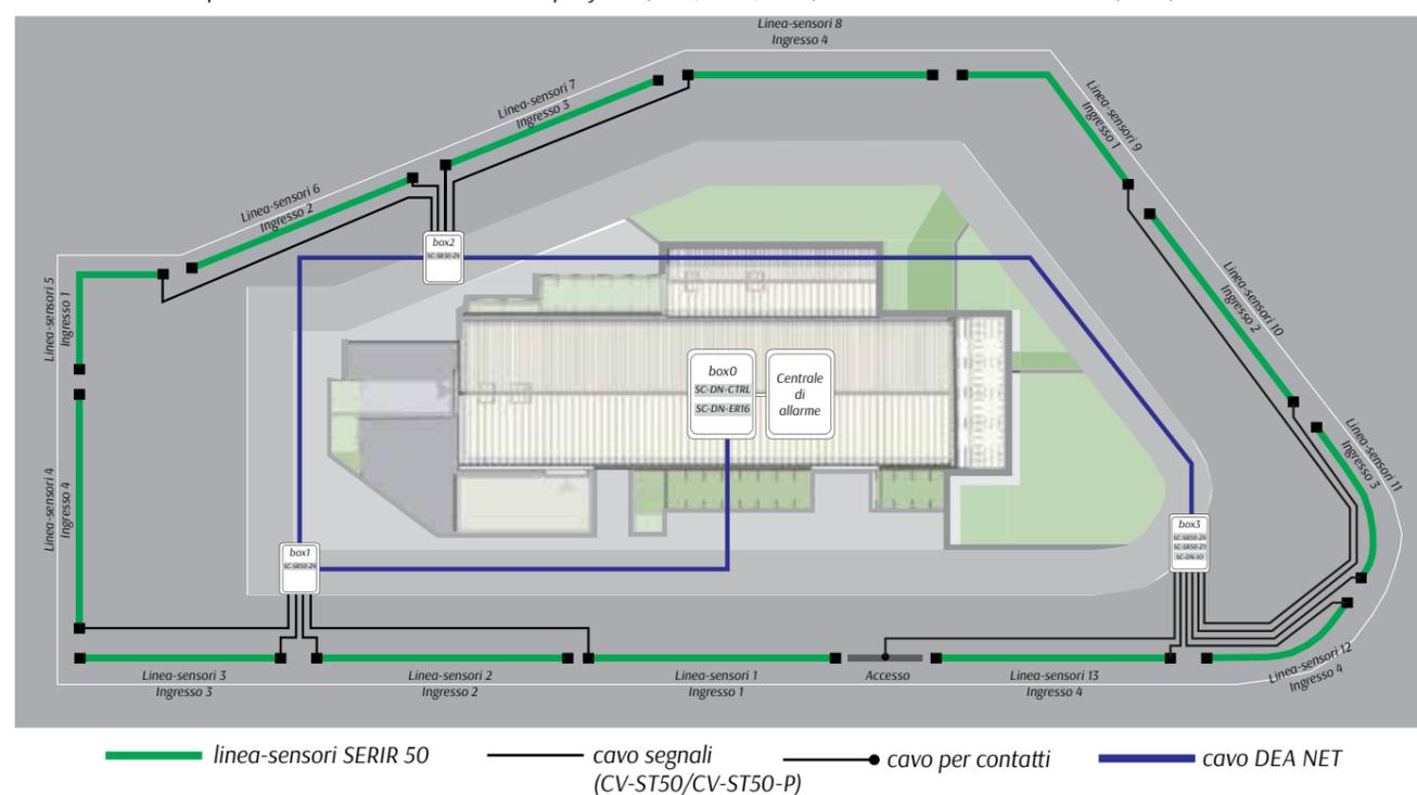
Ogni armadio dev'essere asservito da una linea di alimentazione a 230 Vca e da una linea dati in rame o, tramite apposito convertitore, in fibra ottica. Nel caso in cui non si desideri centralizzare le segnalazioni con **DEA NET**, l'armadio periferico viene configurato in **modalità stand-alone**.
